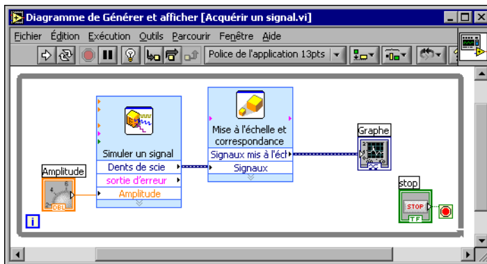
Figure 1-8. Diagramme du VI “Acquérir un signal”
